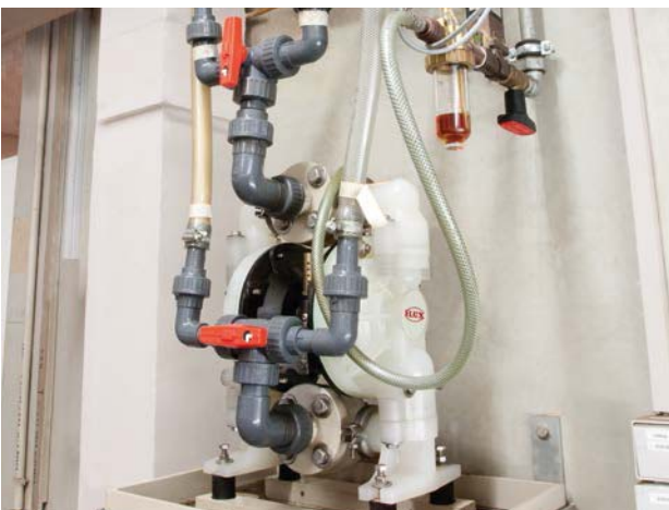
FDM Выкачивание химического никеля для гальванической ванны
