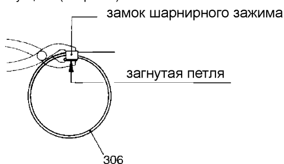
Рис. 9: Прижатие петли шарнирного зажима к замку шарнирного зажима
